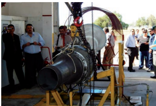
Prueba en banco de un TFE731-2-2N de Pampa de la Fuerza Aérea
